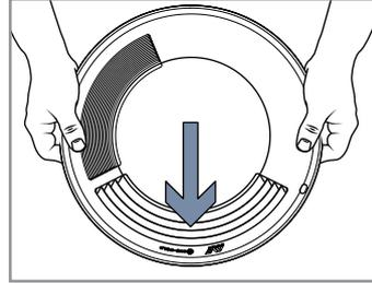
Agite el contenido de la batea moviendo la batea de lado a lado, y asegurándose de que el material no se derrame. No utilice un movimiento circular muy fuerte.
